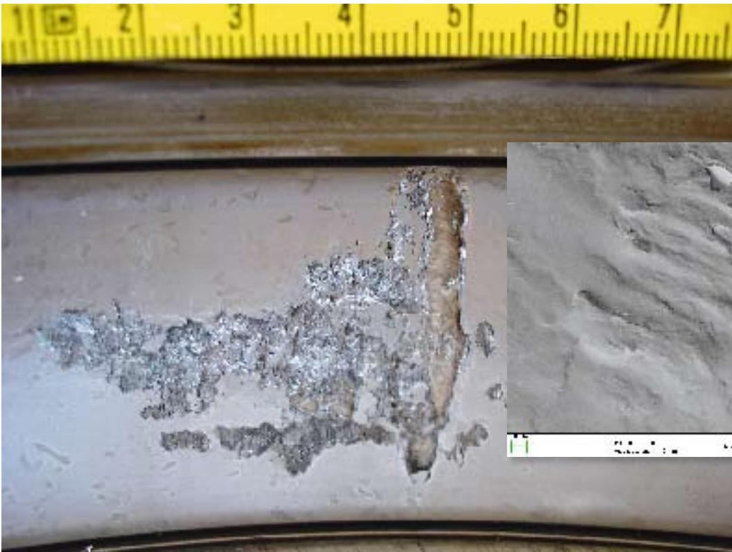
Abb. 1 (li.): Außenring Zylinderrollenlager, betriebsbedingte Abnutzung oder Werkstofffehler? Die Antwort gibt Abbildung 2.
