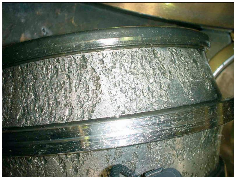
Abbildung 2: Massive Schälungen am Innenring eines Wälzlagers
