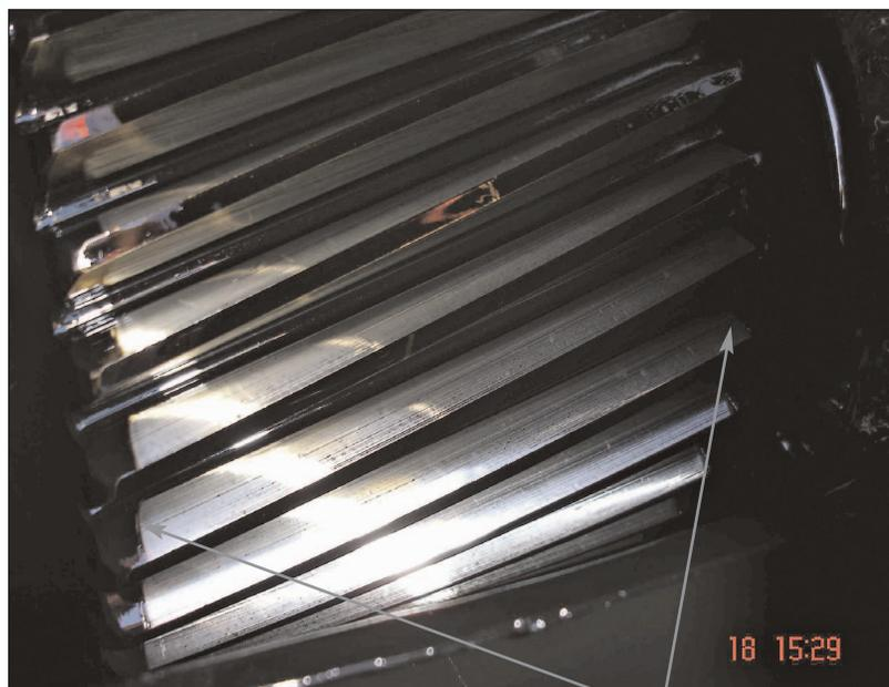
Abbildung 1: Abtriebsritzel nach 10 Jahren im Einsatz, die Zahnspeigel sind metallisch blank.
