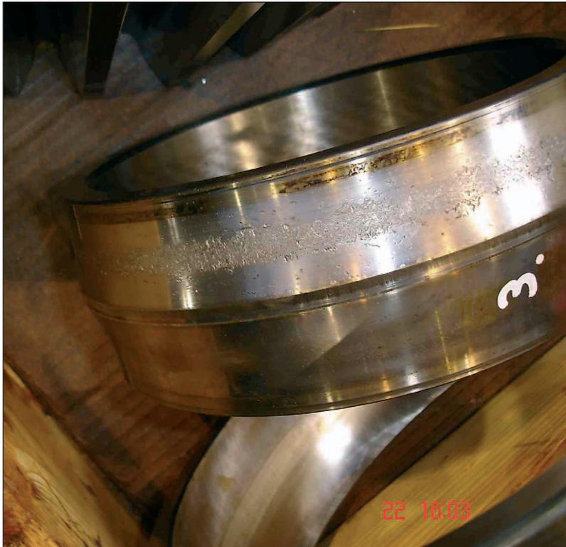
Abbildung 4: Innenring mit Anschmierungen an einer Laufbahn
